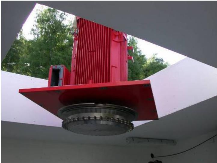
Dans le cadre de la rénovation et de l'extension du réseau d'eau potable, la commune de St-Martin a décidé d'utiliser la charge hydraulique (chute brute disponible de 679m) pour produire de l'énergie hydroélectrique au moyen d'une mini-centrale de turbinage, située en amont du hameau de Gréféric. La production annuelle moyenne s'élève à environ 900'000 kWh.
